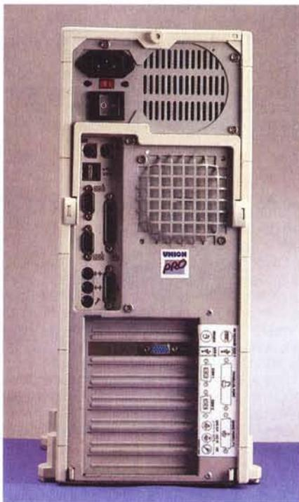
Primo piano sul retro del computer. Le connessioni, in standard ATX, sono tutte localizzate sulla sinistra, comprese le connessioni I/O della scheda audio. L'unica dislocata su di una barra d'espansione è quella dell'output VGA.
