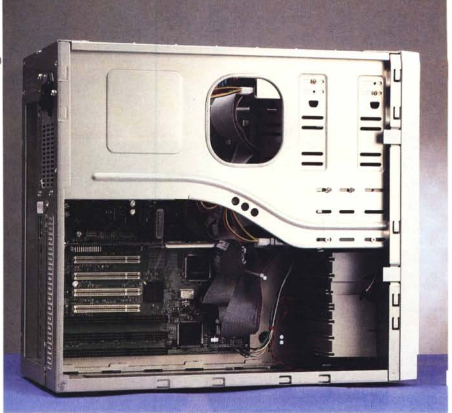
Siamo all'interno, ed è in evidenza il buon assemblaggio del tutto; lo spazio a disposizione è molto e ciò rende più facili le operazioni di aggiornamento e manutenzione.
