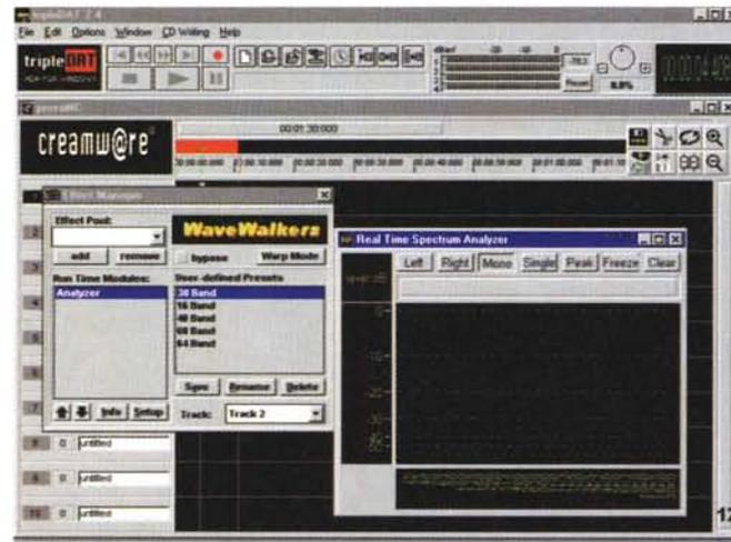
Altrettanto coreografico, ma di estrema utilità, l'ambito Real Time Spectrum Analyzer, fino a 64 bande di analisi e per livelli audio intorno ai -50 dB, anch'esso operante in stretto tempo reale.
