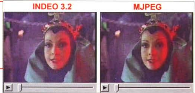
Figura 3 - La seconda codifica di confronto AVI-Indeo 3.2/AVI-Mjpeg. In questo caso va evidenziata la migliore sincronizzazione audio/video che MJPEG, in quanto più leggero come data-rate, offre rispetto ad Indeo 3.2.
