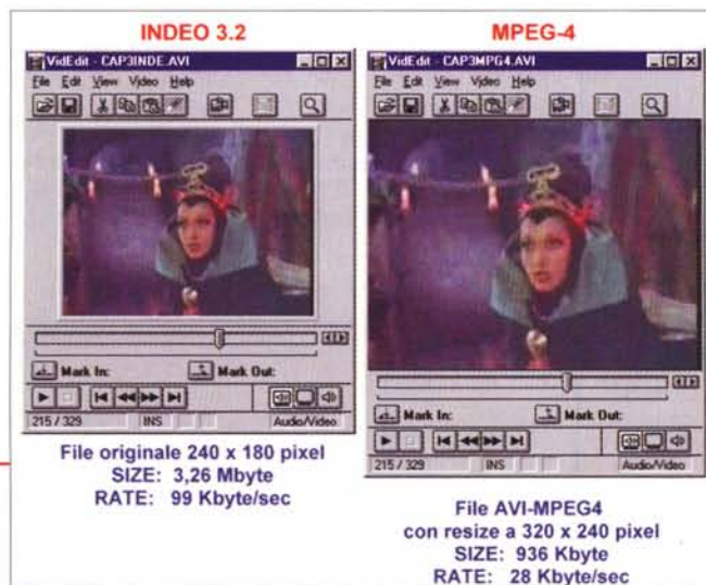
Figura 7 - A confronto il terzo-file campione (da 240x180 pixel) e quello derivato MPEG-4 con il resize a 320x240.
