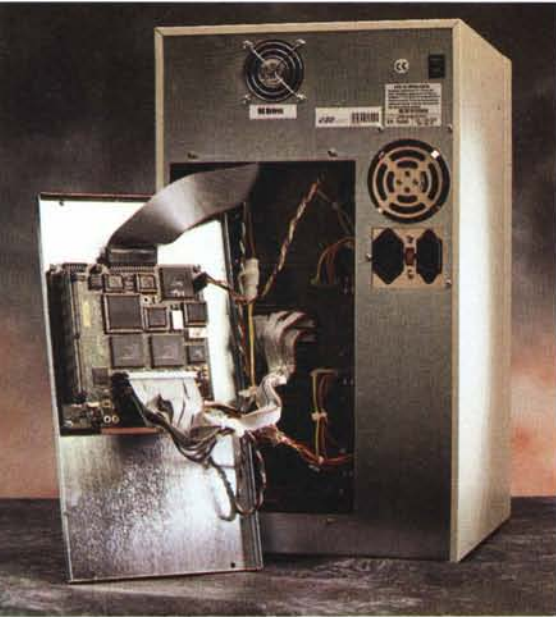
Al suo interno, tutta l'elettronica di gestione è presente sulla scheda in evidenza, al cui interno si possono intravedere l'Intel i960, la RAM di sistema e le interfacce SCSI dei drive.
