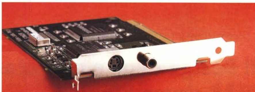
Particolare degli ingressi della Stinger; si nota il connettore d'ingresso S-Video per le sorgenti video.
