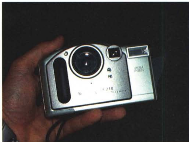
Anche la Kodak DC 210 Zoom utilizza un sensore CCD da 810.000 pixel.
