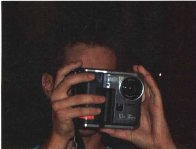
La Sony Mavica salva su floppy disk, ma ha una qualità immagine bassa.
