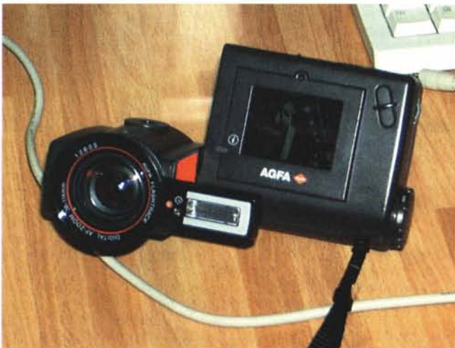
L'Agfa ePHOTO 1280 con sensore CCD da 810.000 pixel.
