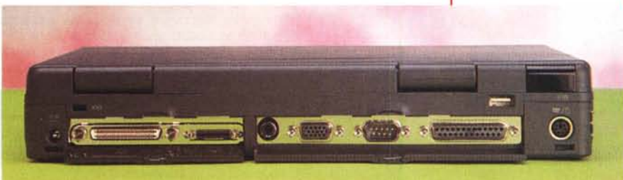
Accanto agli slot PCMCIA, la piccola ventola di raffreddamento. In basso le connessioni per il mondo esterno, la porta a raggi infrarossi e la presa USB.
