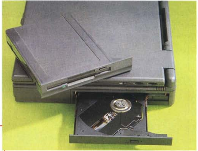
La batteria ricaricabile assicura un'autonomia di funzionamento più che soddisfacente. A destra il lettore di CD-ROM e l'unità floppy disk intercambiabili.
