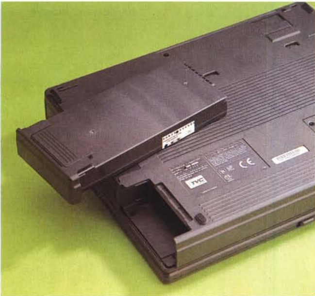
La batteria ricaricabile assicura un'autonomia di funzionamento più che soddisfacente. A destra il lettore di CD-ROM e l'unità floppy disk intercambiabili.
