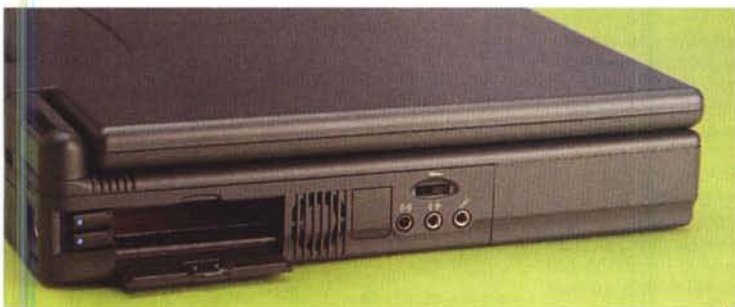
Accanto agli slot PCMCIA, la piccola ventola di raffreddamento. In basso le connessioni per il mondo esterno, la porta a raggi infrarossi e la presa USB.
