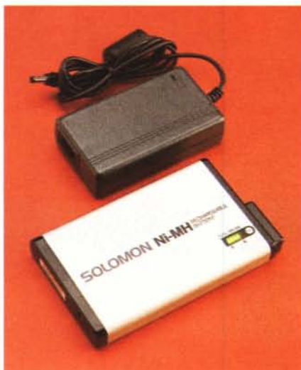
L'alimentatore davvero piccolo e la batteria in dotazione con l'indicatore di carica.
