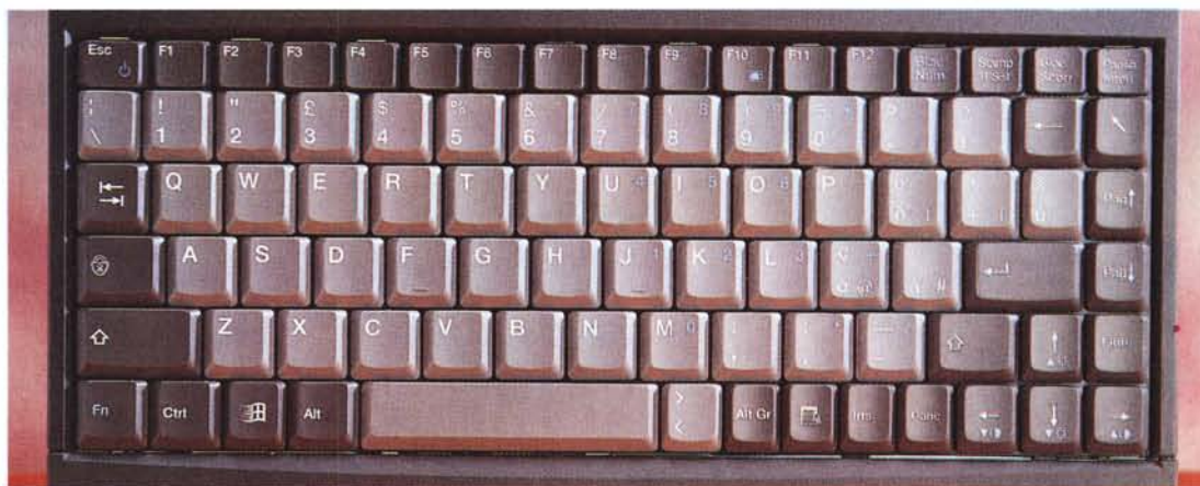
Standard la posizione della tastiera ma non altrettanto il layout con i tasti di INS e CANC accanto alla barra spazio. In alto si notano il pulsante di accensione, i Led dello stato e gli altoparlanti stereo.
