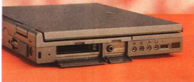
Sul lato sinistro trovano posto gli slot PCMCIA, l'uscita TV, le prese audio, la rotella del volume e la finestrella dell'interfaccia infrarossa.
