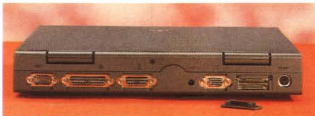
Il retro del computer mostra i connettori essenziali, non protetti, e il connettore di accesso al Bus, protetto da un tappo di gomma.
