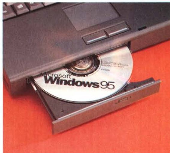
Il lettore di CD-ROM 10x e il touchpad leggermente spostato a sinistra per lasciare posto, internamente, al disco rigido.
