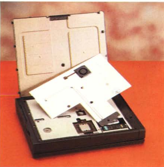
Il generoso dissipatore di alluminio con la ventolina incorporata e la heat-line per distribuire più rapidamente il calore.
