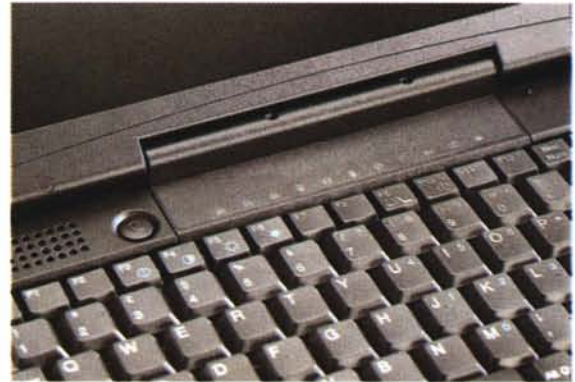
Lo stato della macchina viene indicato da una serie di Led e non dal solito pannello a cristalli liquidi.
