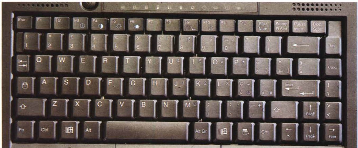
Standard la tastiera sia come layout che come posizionamento. Si notano in alto i due altoparlanti stereo e l'interruttore di accensione.
