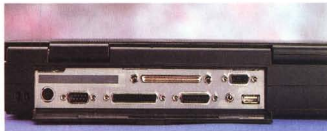
Sul retro, oltre alle porte classiche di tutti i PC, ci sono le uscite video per CRT e TV, la seriale USB e il connettore per le espansioni. Si nota in alto a sinistra lo spazio libero per un ulteriore slot PCMCIA o una scheda Modem.
