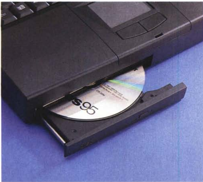
Il lettore di CD nella sua sede ed estratto. La versione fotografata è un 10x ma l'Enface sarà venduto con un 20x.
