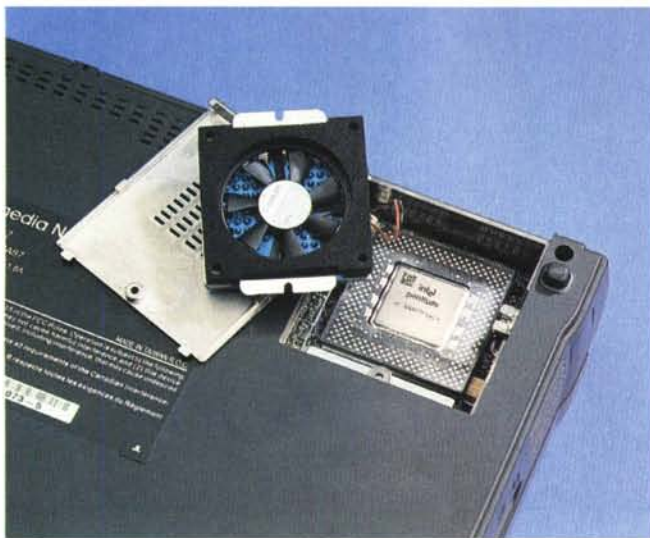
I Pentium MMX a 200 MHz e il dissipatore con la ventola incorporata.
