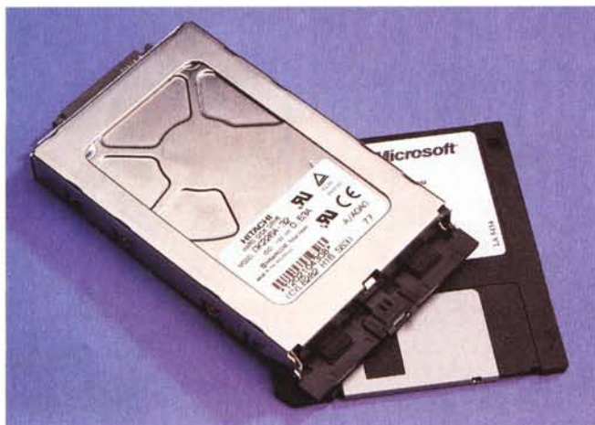
Il minuscolo hard disk da 3.2 GByte confrontato con un "enorme" floppy.
