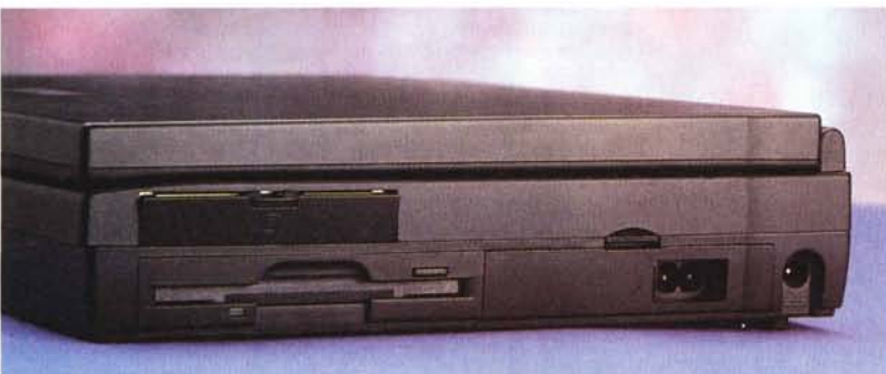
Sul retro, oltre alle porte classiche di tutti i PC, ci sono le uscite video per CRT e TV, la seriale USB e il connettore per le espansioni. Si nota in alto a sinistra lo spazio libero per un ulteriore slot PCMCIA o una scheda Modem.
