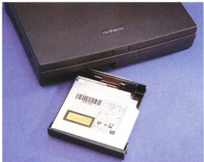
Il lettore di CD nella sua sede ed estratto. La versione fotografata è un 10x ma l'Enface sarà venduto con un 20x.
