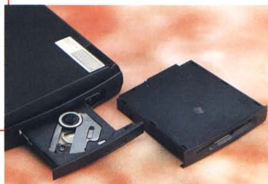
In posizione di lavoro la tastiera si inclina ergonomicamente verso l'utente. In alto le connessioni per il mondo esterno; a destra il lettore CD-ROM intercambiabile con l'unità floppy disk; in basso quest'ultima collegata esternamente tramite l'accluso cavetto.
