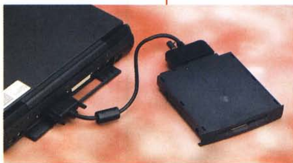
In posizione di lavoro la tastiera si inclina ergonomicamente verso l'utente. In alto le connessioni per il mondo esterno; a destra il lettore CD-ROM intercambiabile con l'unità floppy disk; in basso quest'ultima collegata esternamente tramite l'accluso cavetto.
