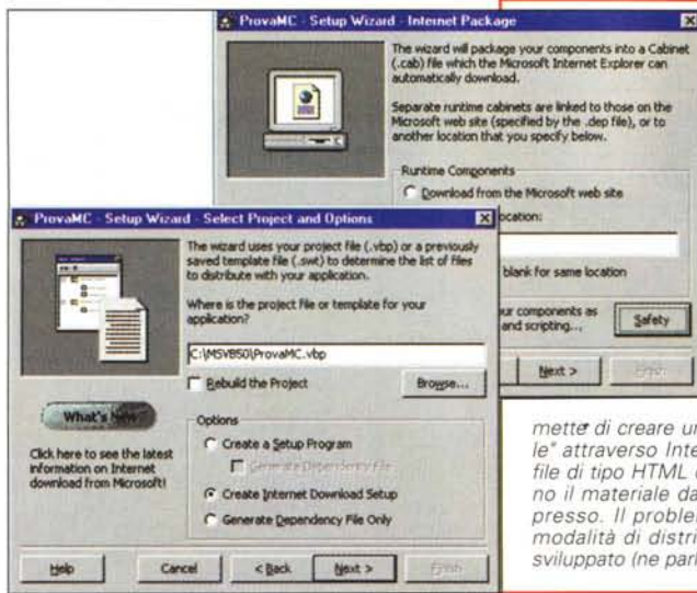
Figura 8 - MS Visual Basic 5.0 - Il Setup Wizard. I vari Wizard di cui abbiamo parlato nelle precedenti didascalie (e anche altri di cui non abbiamo parlato in questo articolo) si lanciano dall'interno dell'ambiente di sviluppo di Visual Basic. C'è anche il Setup Wizard, che invece è esterno, il cui compito è quello di produrre il file eseguibile "finale". Una variante di questa procedura (la vediamo nella figura) è quella che permette di creare un'applicazione "downloadabile" attraverso Internet. Vengono generati sia file di tipo HTML che file CAB, che contengono il materiale da scaricare in formato compresso. Il problema successivo riguarda le modalità di distribuzione del materiale così sviluppato (ne parliamo nel testo).
