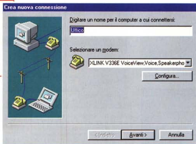
Figura 1 - Per collegarsi ad un computer configurato come "Server", la prima operazione da eseguire è quella di creare una connessione di Accesso Remoto per effettuare il collegamento telefonico. Nella prima schermata di preparazione della nuova connessione, oltre a definire il nome della stessa, è bene controllare che il modem sia correttamente riconosciuto.
