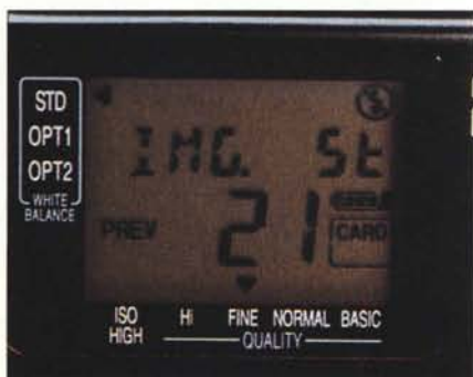
Quattro "schermate" tratte dal piccolo display LCD della Fujix DS-300 per la regolazione di alcuni parametri di setup. Normalmente il display mostra i valori di esposizione e l'autonomia residua di ripresa.
