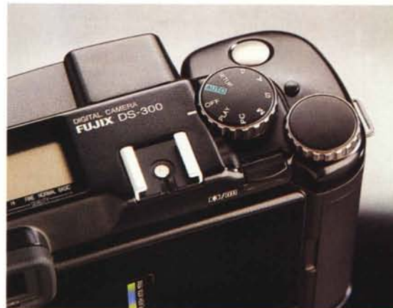
I comandi della Fujix DS-300 sono molto simili a quelli di una fotocamera tradizionale. Qui vediamo il pulsante di scatto e la ghiera dei modi operativi.
