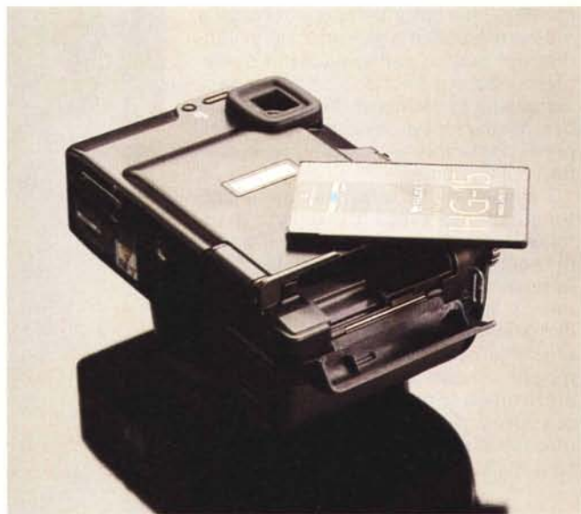
La batteria ricaricabile è agli ioni di litio, del tutto simile a quelle utilizzate nelle moderne videocamere. A destra la scheda di memoria PCMCIA da 15 megabyte.
