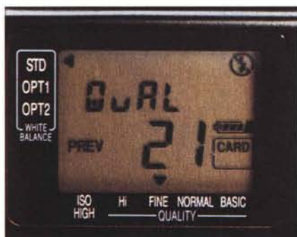
Quattro "schermate" tratte dal piccolo display LCD della Fujix DS-300 per la regolazione di alcuni parametri di setup. Normalmente il display mostra i valori di esposizione e l'autonomia residua di ripresa.
