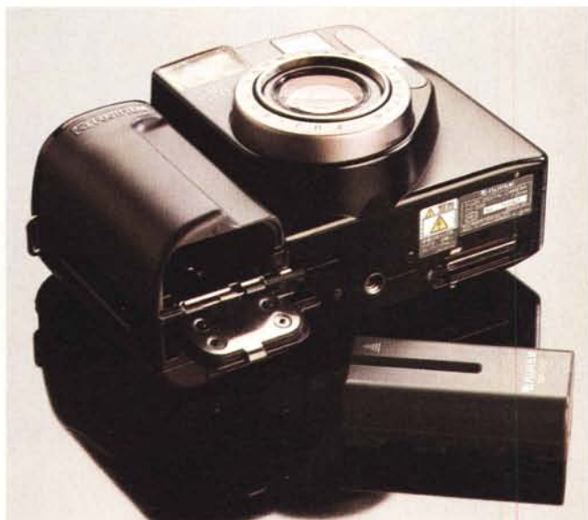
La batteria ricaricabile è agli ioni di litio, del tutto simile a quelle utilizzate nelle moderne videocamere. A destra la scheda di memoria PCMCIA da 15 megabyte.
