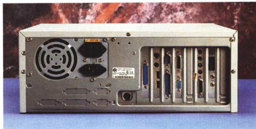
Sul retro della macchina sono visibili, da sinistra verso destra, le connessioni della porta parallela, mouse, remote ad infrarossi, porte seriali, Input/Output del blocco VGA/Video, mini-jack audio e porta-joystick della SoundBlaster ed infine le connessioni del modem.
