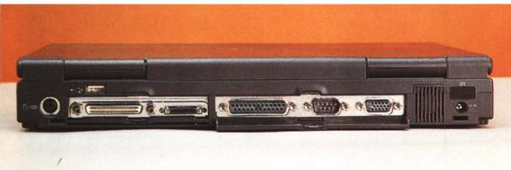
Tra le connessioni "per il mondo esterno" disponibili sul retro, la più interessante è la porta USB: permette il collegamento di ben 127 nuovi dispositivi esterni.
