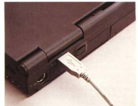
Tra le connessioni "per il mondo esterno" disponibili sul retro, la più interessante è la porta USB: permette il collegamento di ben 127 nuovi dispositivi esterni.
