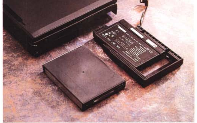
Sulla sinistra l'alloggiamento della batteria, uno slot PCMCIA, l'HD da 2,1 GB e il floppy sostituibile con la seconda batteria.
