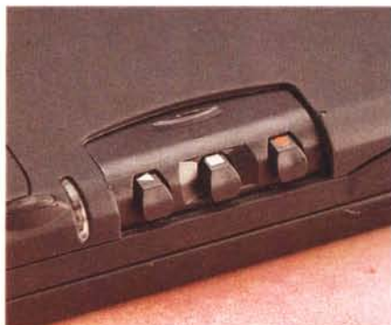
A sinistra i pulsanti per l'attivazione "esterna" del registratore digitale. Al centro l'alloggiamento per le CompactFlash Card, a destra la batteria di backup.
