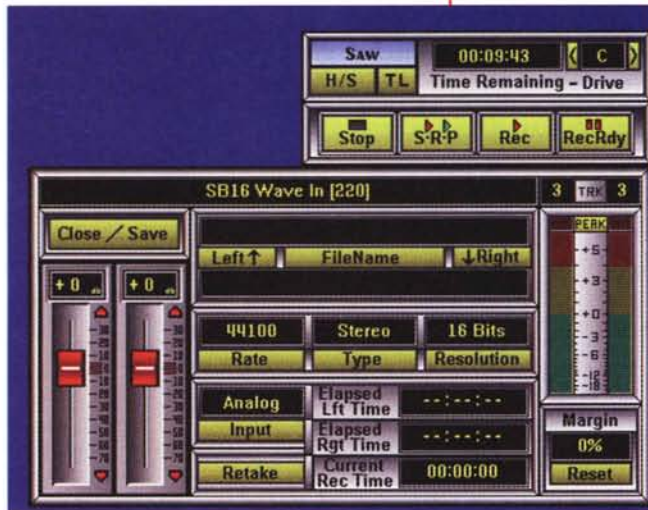
Figura 12 - Software Audio WorkShop. I moduli di registrazione dell'applicativo. Una volta effettuata la registrazione (direttamente dai controlli presenti in ciascuna delle quattro track-bar) la sintesi acquisita sarà immediatamente disponibile per essere editata, marcata ed effettata.
