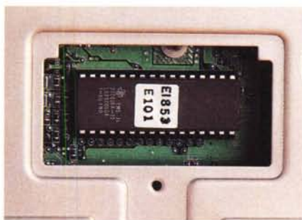
L'EPROM contenente il firmware dello scanner, facilmente accessibile dal fondo: upgrade in vista? A destra un dettaglio sulla porta SCSI disponibile anche su connettore 25 pin. Il terminatore è incorporato.
