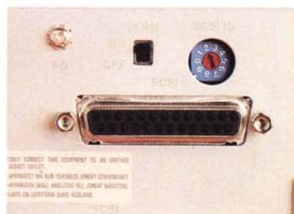
L'EPROM contenente il firmware dello scanner, facilmente accessibile dal fondo: upgrade in vista? A destra un dettaglio sulla porta SCSI disponibile anche su connettore 25 pin. Il terminatore è incorporato.
