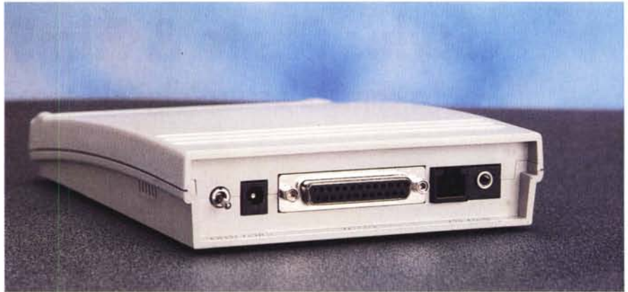
Il retro del modem dove si nota la mancanza dell'uscita RS 11 per il telefono.
