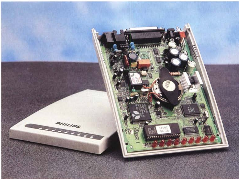
Il modem aperto: ordinato il layout e ben curata la separazione funzionale.
