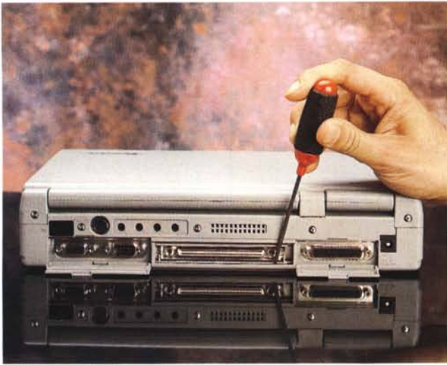
Sul retro le connessioni per le periferiche sono tutte protette da sportellini di sicurezza. A destra i moduli rimovibili del Tecra 740.
