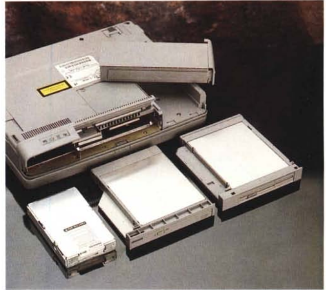
Sul retro le connessioni per le periferiche sono tutte protette da sportellini di sicurezza. A destra i moduli rimovibili del Tecra 740.
