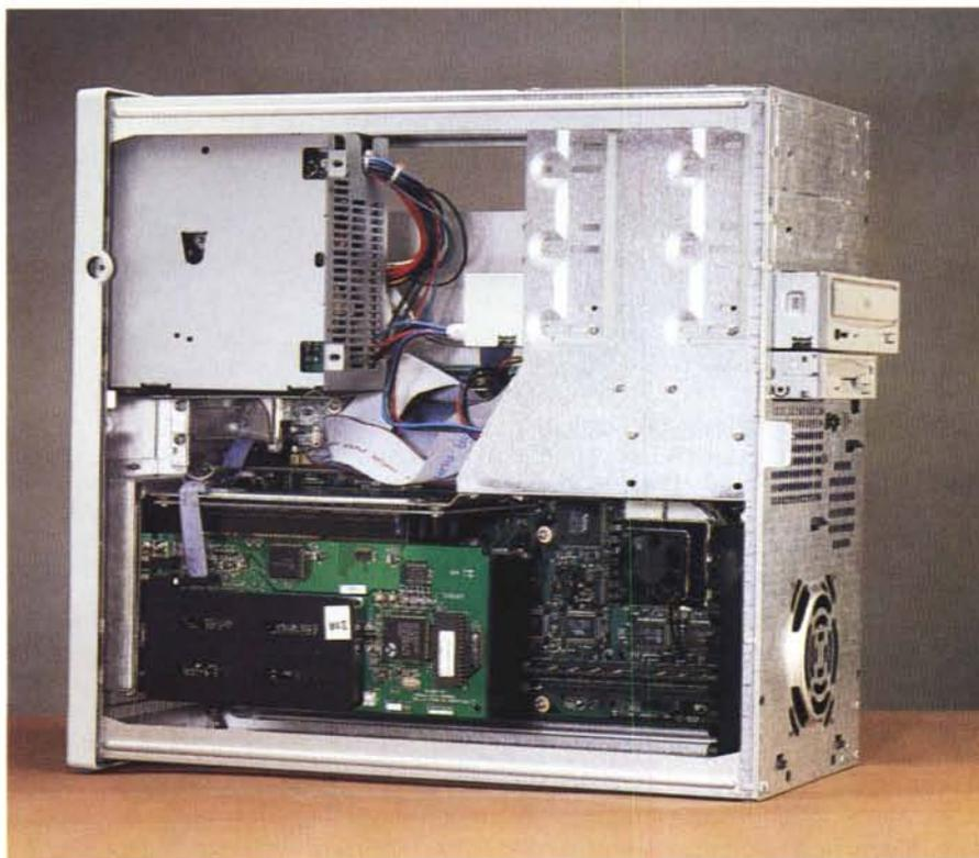
L'interno del computer con in bella mostra il grosso Modem Supra e in secondo piano il processore Pentium 200 MMX.
