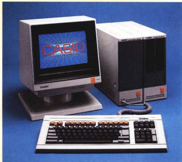
Il Casio FP-6000 era una macchina assai interessante: "CPU 8086 a 8 MHz, 256K RAM espandibili a 768, grafica 600x400 pixel singolarmente indirizzabili in 8 colori". Libidine!
