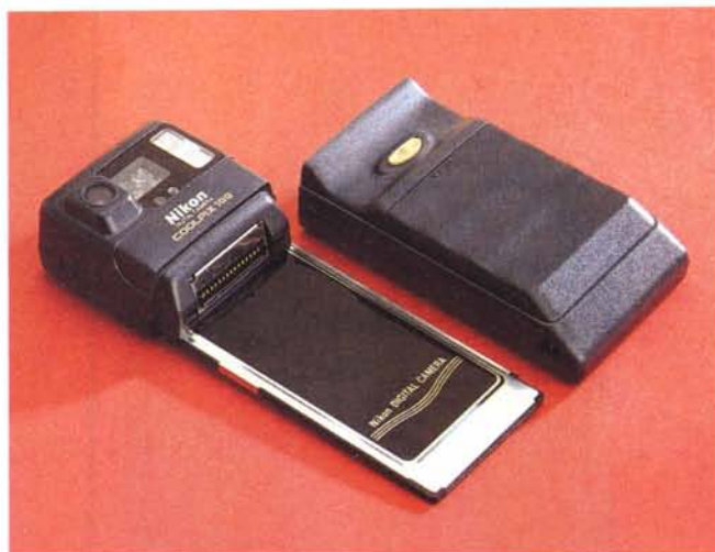
Il lato superiore dell'impugnatura contiene le quattro pile stilo per l'alimentazione della macchina. Rimuovendola completamente scopriamo la sua appendice PCMCIA per il trasferimento delle immagini riprese su computer.
