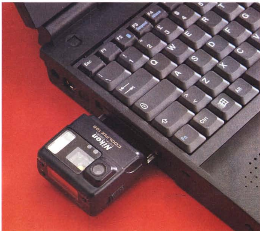
La COOLPIX 100 inserita in un alloggiamento PCMCIA di un computer portatile. Le immagini riprese sono salvate singolarmente in formato JPEG.
