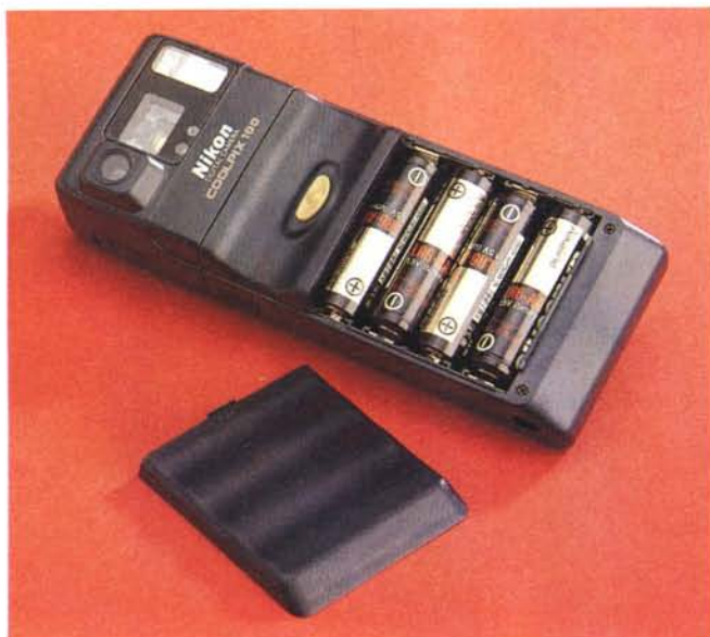
Il lato superiore dell'impugnatura contiene le quattro pile stilo per l'alimentazione della macchina. Rimuovendola completamente scopriamo la sua appendice PCMCIA per il trasferimento delle immagini riprese su computer.
