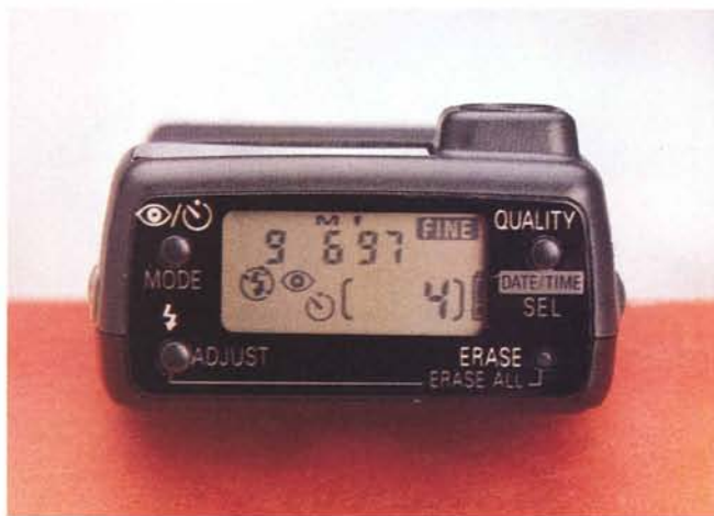
La "sezione fotocamera" della COOLPIX 100 è di dimensioni veramente ridotte. Incorpora un flash elettronico e un display LCD per regolare le varie funzioni.
