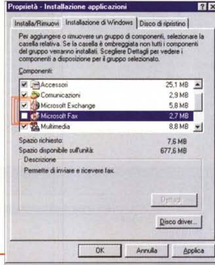
Figure 1 e 2 - All'interno del pannello di controllo vi è il dispositivo "Installa applicazioni", attraverso il quale si può eseguire la rimozione o l'installazione del software creato per Windows 95. Una delle funzioni principali di "Installa applicazioni" è quella di aggiungere o rimuovere dall'hard disk le applicazioni presenti sul CD-ROM del sistema operativo. E' proprio attraverso tale procedura che si deve eseguire l'installazione di "Microsoft Fax".
