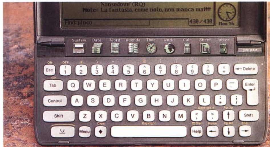
In basso la tastiera dello Psion Serie 3c. Qui a lato il palmtop visto di profilo: si noti il piccolo supporto ergonomico per la tastiera.
