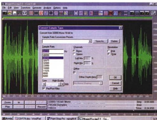
Figura 1 - Per convertire preventivamente a 16 bit/32 kHz (minimi) i parametri di un file .wav, va attivato il pannello Convert Sample Type.
