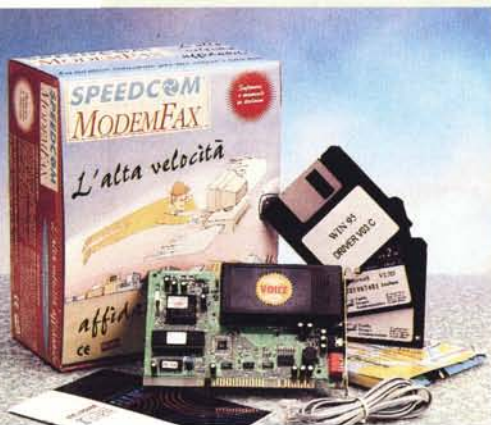
La versione interna di questo modem; spicca l'isolamento della sezione telefonica realizzato con un opportuno guscio plastico.
