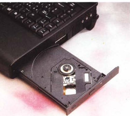
Il Geo Challenge è una macchina molto modulare. Il lettore di CD-ROM, a velocità 10x, è situato sul lato destro: l'unità floppy disk può, all'occorrenza, essere sostituita da una seconda batteria.
