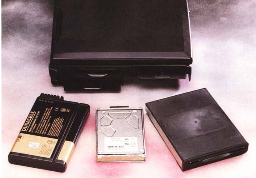
Il Geo Challenge è una macchina molto modulare. Il lettore di CD-ROM, a velocità 10x, è situato sul lato destro: l'unità floppy disk può, all'occorrenza, essere sostituita da una seconda batteria.
