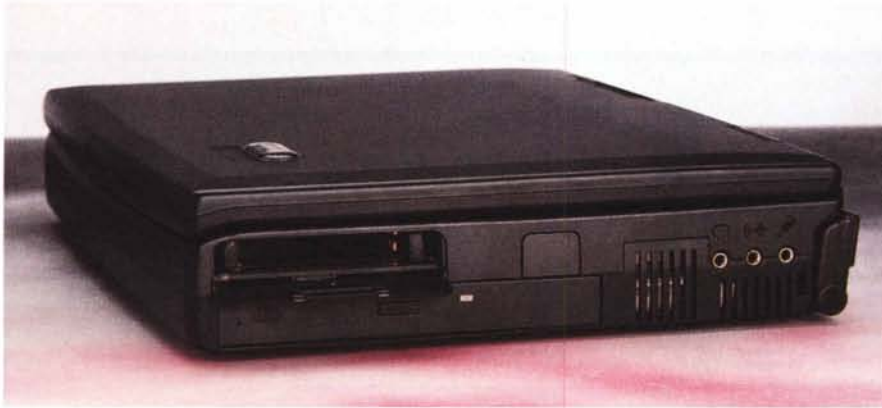
Sul lato destro del Geo troviamo il secondo alloggiamento per le schede PCMCIA di tipo II e III. A lato la sede del microprocessore con la sua indispensabile ventola di aerazione.
