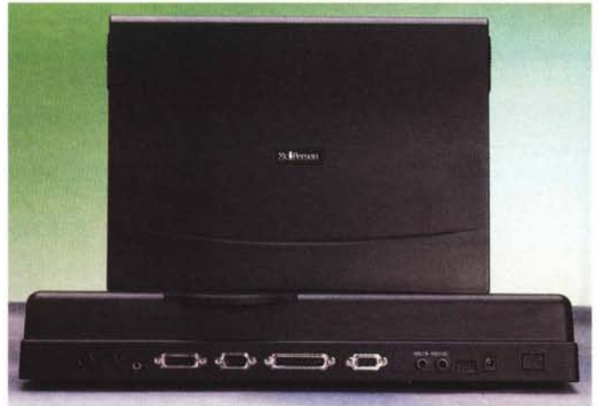
Il replicatore di porte offre in più un ingresso joystick, un'uscita videocomposita e una coppia di altoparlanti stereo amplificati.
