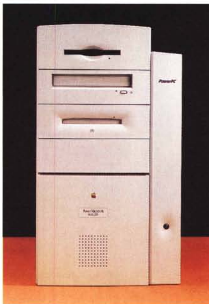
L'aspetto solido e robusto dell'8600 dovuto al nuovo case mini tower. Da notare il driver lomega Zip da 100 MB installato di serie.
