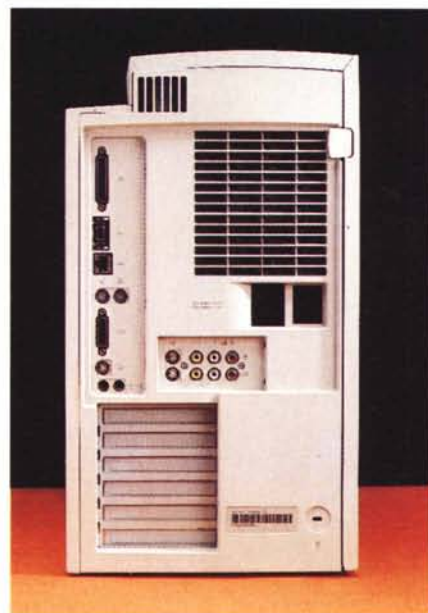
Sul retro i connettori per le periferiche e l'alimentazione. Si nota in alto a destra la leva di blocco apertura che può essere fissata con un semplice lucchetto.
