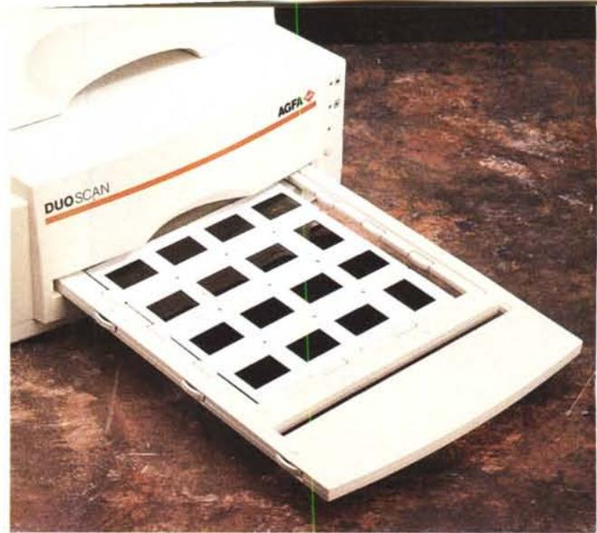
*Nel cassetto per gli originali trasparenti possiamo inserire sia singoli "fotocolor" che diapositive anche di formato differente. La digitalizzazione simultanea di più originali può avvenire in modalità "batch".*
