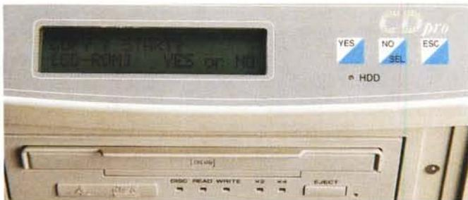
*Il semplicissimo pannello operativo permette di selezionare tutte le funzioni. Nella foto a destra, il CD Pro SR-4400 smontato: si noti la scheda a microprocessore.*
