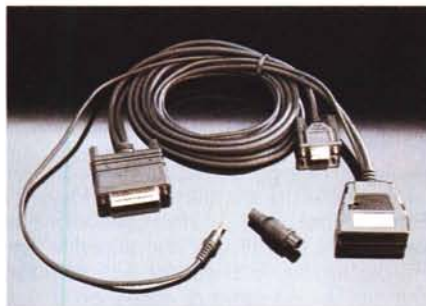
L'originale fattura dello SmartCable, da collegare da un capo alla porta seriale del PC, dall'altro al Control-L della macchina "master" (di solito un camcorder) e, tramite l'infrared remote, alla macchina "slave" (il videoregistratore in registrazione).
