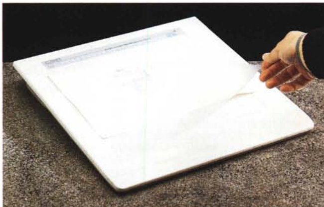
La Wacom UltraPad è dotata di un pratico foglio plastico trasparente che permette di fissare gli originali da digitalizzare.
