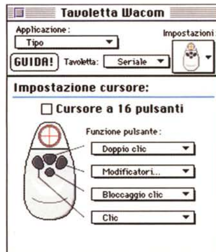
Una serie di ulteriori impostazioni riguardanti lo stilo UltraPen Eraser ed il cursore ergonomico UltraPoint UC-520. L'impostazione riguardante il riconoscimento dell'inclinazione della penna è automaticamente disattivata se si impiega il cursore.
