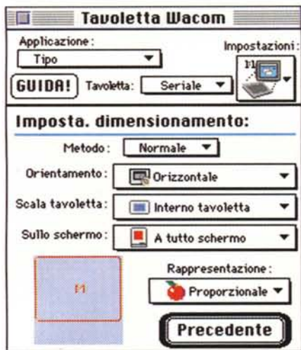
Le impostazioni relative al posizionamento e dimensionamento della superficie utile rispetto alle schermo sono molto utili. I restanti pannelli permettono di impostare i parametri relativi alla connessione e di definire i tasti funzione programmabili della tavoletta.
