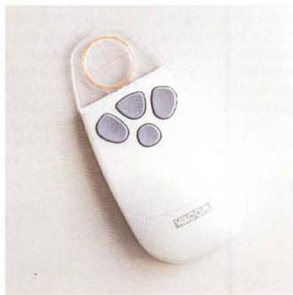
Alcuni esempi di stilo, diversi per tipo e genere di applicazioni, disponibili nella dotazione standard o in opzione ed il cursore ergonomico UltraPoint a 4 tasti. Si noti nel cursore il crocino di registro per una migliore precisione di digitalizzazione.
