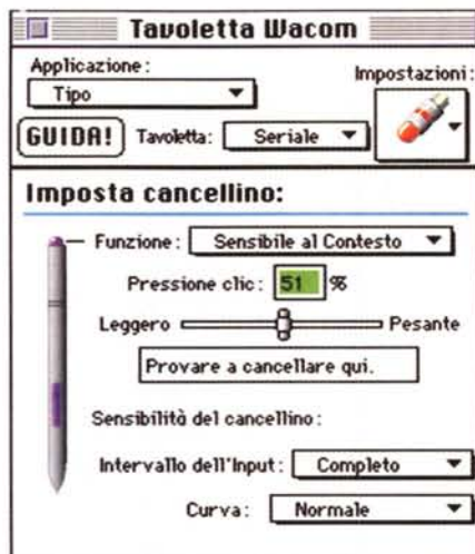
Una serie di ulteriori impostazioni riguardanti lo stilo UltraPen Eraser ed il cursore ergonomico UltraPoint UC-520. L'impostazione riguardante il riconoscimento dell'inclinazione della penna è automaticamente disattivata se si impiega il cursore.
