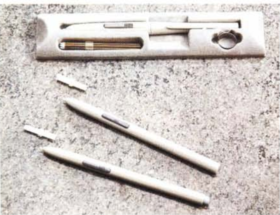
Alcuni esempi di stilo, diversi per tipo e genere di applicazioni, disponibili nella dotazione standard o in opzione ed il cursore ergonomico UltraPoint a 4 tasti. Si noti nel cursore il crocino di registro per una migliore precisione di digitalizzazione.
