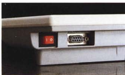
Un particolare dell'interruttore di alimentazione e della connessione seriale DB9 e la serie di tasti programmabili che sovrasta la superficie sensibile.
