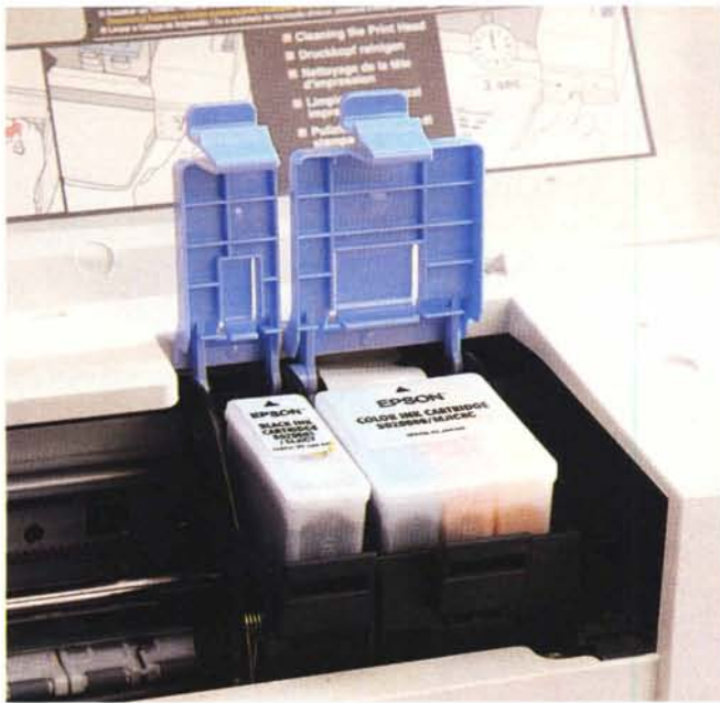
In alto il pannello di controllo della EPSON Stylus Color 600 e, a sinistra, la testina di stampa con le due taniche per gli inchiostri.
