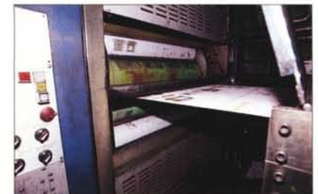
I "sedicesimi" fotografati al volo all'uscita delle unità di stampa del ciano, del magenta e del giallo. L'ultimo "tocco" lo dà il passaggio del nero.
