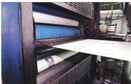
I "sedicesimi" fotografati al volo all'uscita delle unità di stampa del ciano, del magenta e del giallo. L'ultimo "tocco" lo dà il passaggio del nero.
