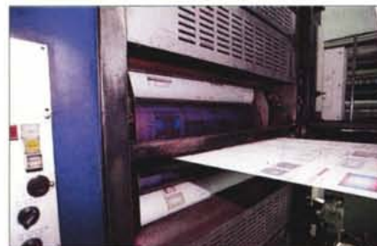
I "sedicesimi" fotografati al volo all'uscita delle unità di stampa del ciano, del magenta e del giallo. L'ultimo "tocco" lo dà il passaggio del nero.
