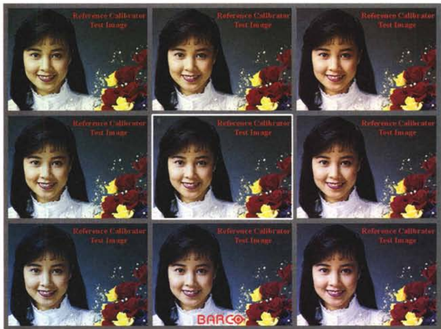
In questa tabella, messa a punto dalla Barco, sono mostrate le differenze di 6 "delta E" nello spazio metrico CIE L^*a^*b^* . Immagini confinanti hanno un "delta E" di 6, le immagini non confinanti (sommando le differenze relative) distano tra loro 12 "delta E".
