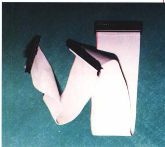
Figura 4 - Per collegare due periferiche sullo stesso controller è necessario utilizzare un cavo a tre connettori.
