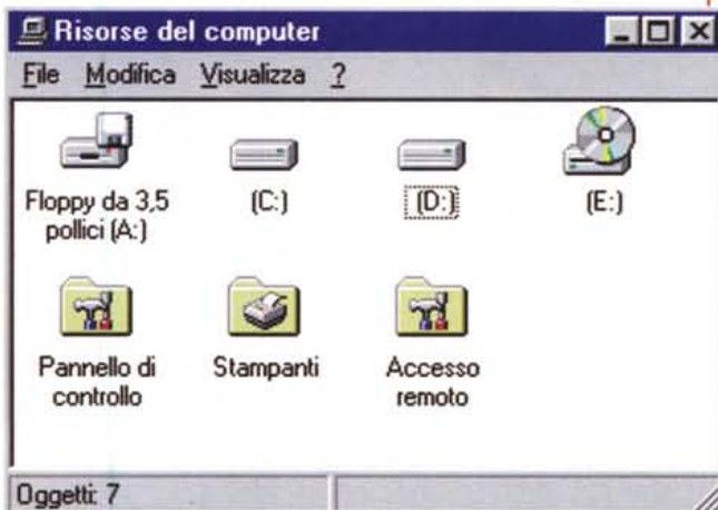
Figura 6 - Dopo l'installazione del secondo disco la situazione si presenta leggermente diversa: è comparsa la nuova icona del secondo disco identificato con la lettera D, mentre al CD-ROM è stata assegnata una lettera nuova: la E. Volendo è possibile mantenere la lettera D per il CD-ROM e far assegnare la nuova lettera al secondo disco. La procedura è specificata nell'articolo.
