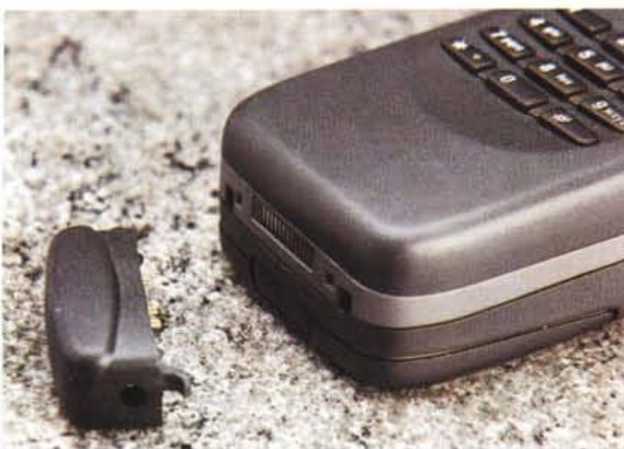
Per collegare l'alimentatore esterno è necessario ricorrere a questo delicato adattatore. A destra un collegamento ottico con l'HP 800 OmniBook.
