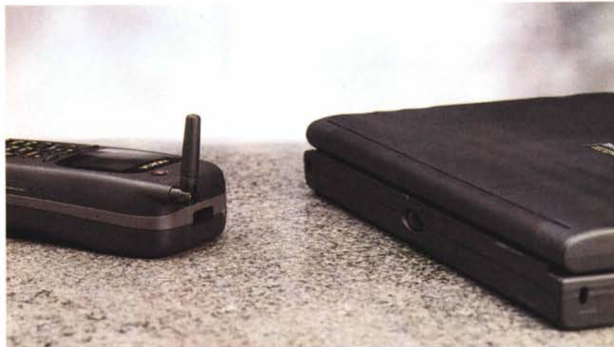
Per collegare l'alimentatore esterno è necessario ricorrere a questo delicato adattatore. A destra un collegamento ottico con l'HP 800 OmniBook.
