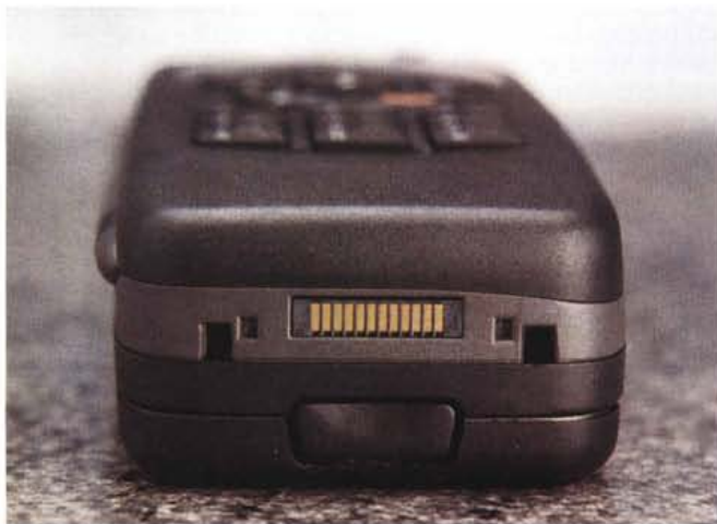
L'estremità inferiore del Nokia 9000 ospita la contattiera per gli accessori. Sul lato superiore troviamo la porta infrarossi e il connettore per l'antenna esterna.
