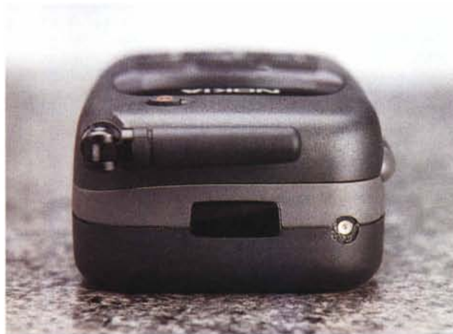
L'estremità inferiore del Nokia 9000 ospita la contattiera per gli accessori. Sul lato superiore troviamo la porta infrarossi e il connettore per l'antenna esterna.
