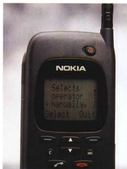
Indugiando su una funzione telefonica richiamata da menu (nell'esempio qui mostrato la selezione automatica o manuale del gestore) dopo qualche secondo compare automaticamente un messaggio di help.
