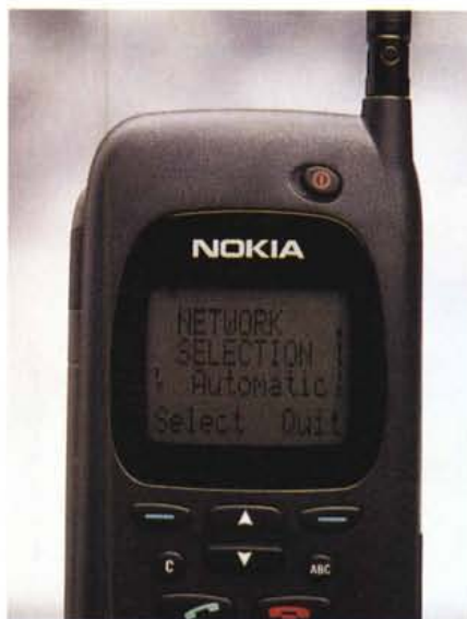
Indugiando su una funzione telefonica richiamata da menu (nell'esempio qui mostrato la selezione automatica o manuale del gestore) dopo qualche secondo compare automaticamente un messaggio di help.
