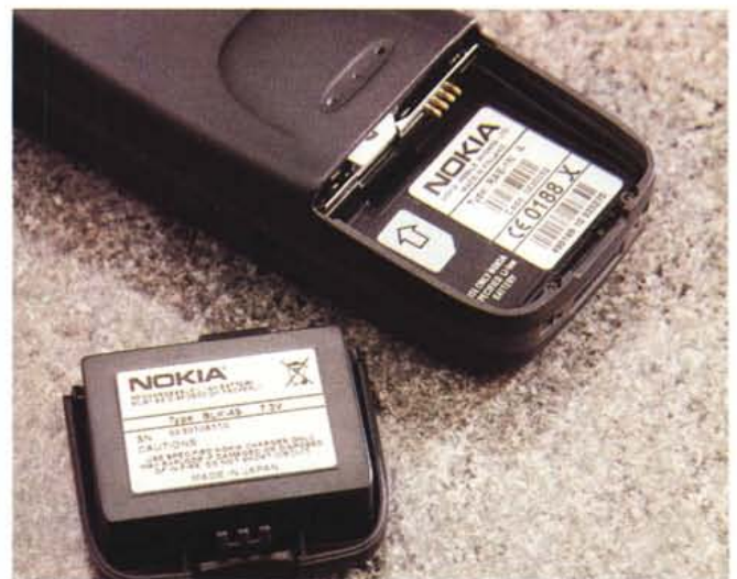
Il vano batteria ospita anche la scheda GSM che rappresenta, come noto, il contratto dell'utente. La batteria è in tecnologia litio e garantisce trenta ore di funzionamento continuato dell'organizer col telefono acceso (in attesa) o due ore di conversazione/collegamento Internet
