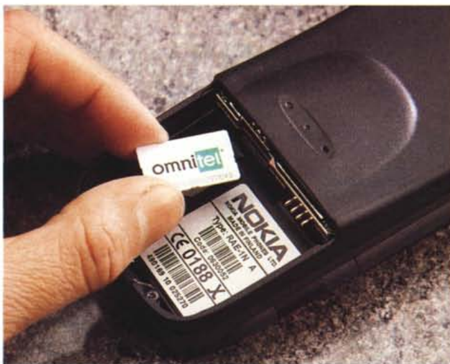
Il vano batteria ospita anche la scheda GSM che rappresenta, come noto, il contratto dell'utente. La batteria è in tecnologia litio e garantisce trenta ore di funzionamento continuato dell'organizer col telefono acceso (in attesa) o due ore di conversazione/collegamento Internet
