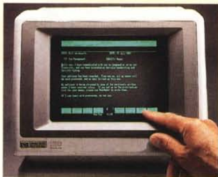
L'HP 150 era un computer gestionale dotato di un ingegnoso touch-screen a LED infrarossi.
