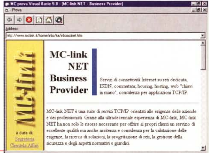
Microsoft Visual Basic 5.0 - E' un nuovo Browser per Internet? No è una Form Visual Basic 5.0. Una novità comodissima per gli sviluppatori è costituita dalla presenza di Form "preprogrammate". Quella mostrata in figura ne è un significativo esempio. Si tratta di un vero e proprio Browser per Internet, con tanto di Pulsantiera, di ComboBox con l'elenco dei Siti raggiunti recentemente, di finestre per visualizzare il Sito, il cui contenuto è totalmente attivo. L'abbiamo lanciata, come Finestra MDI Child, da una Form MDI Padre, dotata di menu. Il tipo di Form va scelto quando si esegue il comando Inserisci Form.
