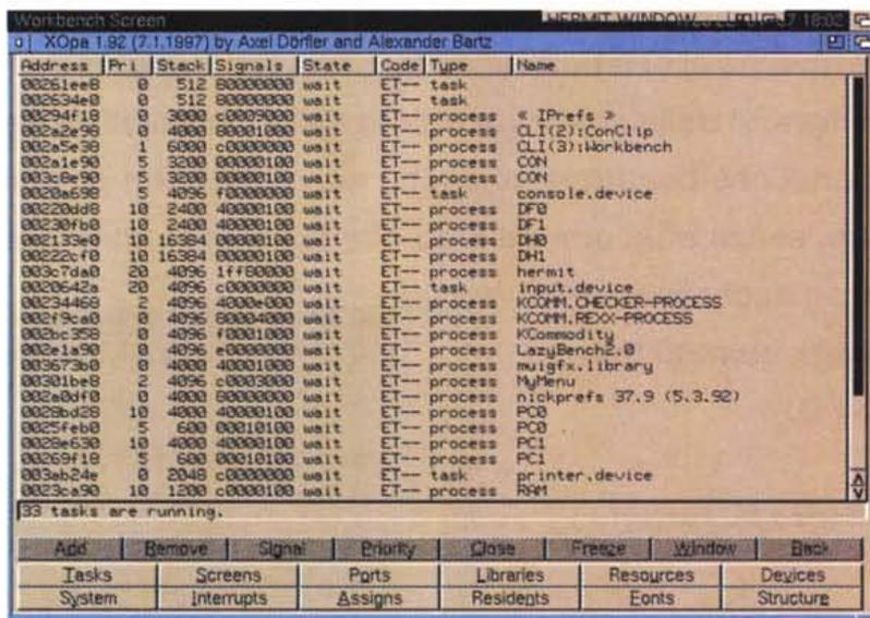
possibile ad esempio "killare" un processo che magari è rimasto aperto, facendo però sempre attenzione a cosa si uccide, in quanto è facile bloccare il sistema se si prova a terminare qualche processo fondamentale in corso. Ogni processo viene dettagliatamente descritto, con indirizzo, stack usato, lo
