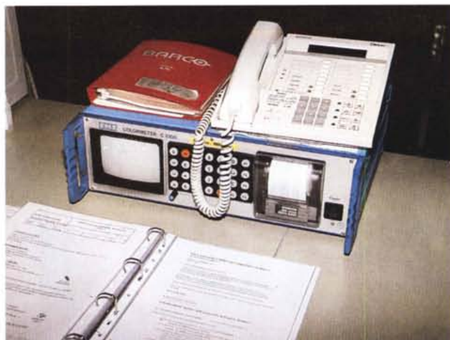
I monitor Barco della serie Reference Calibrator sono tarati in fabbrica uno per uno attraverso un sofisticatissimo radiospettrofotometro (a sinistra e in alto). Qui a lato la sorgente di luce campione utilizzata per tarare, a sua volta, lo strumento di calibrazione.
