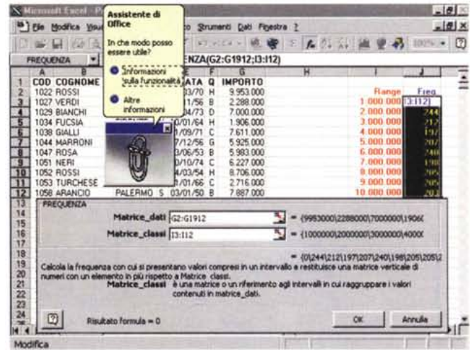
Figura 13 - MS Office 97 - Excel 97 - Due livelli di aiuto usando Excel. Siamo alle prese con un problema di tipo statistico: vogliamo calcolare la distribuzione di frequenza in una serie di valori. In pratica abbiamo circa 1.900 importi e vogliamo contare quanti di questi ricadono tra 1 milione e 2 milioni, quanti tra 2 milioni e 3 milioni, e così via. Si incarica di questo compito una delle numerosissime funzioni di tipo statistico presenti in Excel. L'utente non esperto, ma in generale ne trova giovamento anche quello esperto, sfrutta dapprima la procedura di Autocomposizione delle Funzioni, che lo aiuta operativamente e fornisce anche indicazioni su cosa calcola la specifica funzione, e poi l'Assistente di Office, che è più propriamente uno strumento di Help.
