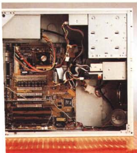
L'interno del Planet 5000 mostra una costruzione accurata, l'unico elemento di disturbo è un collegamento "volante" della scheda audio.
