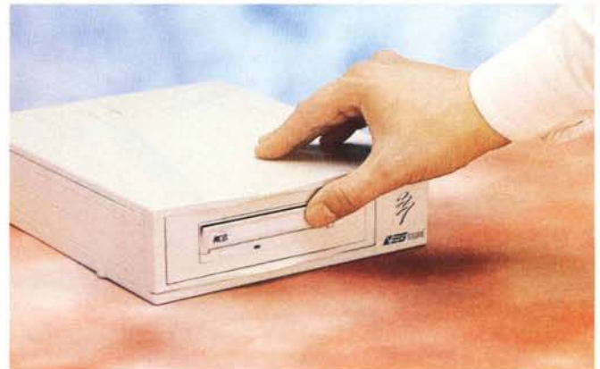
Per inserire un disco nell'unità è necessario prima aprire lo sportellino anteriore e poi richiuderlo manualmente. L'espulsione è automatica (vedi testo).
