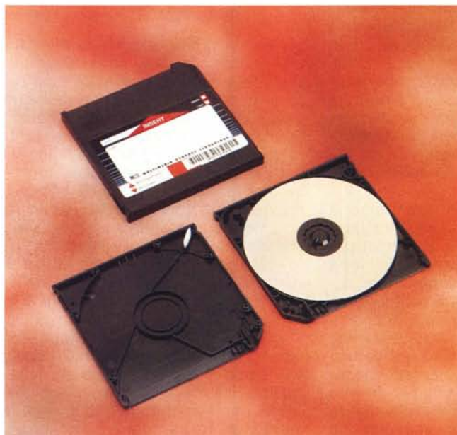
Una cartuccia Nomai 540 smontata. Come vedete si tratta di un vero e proprio hard disk rimovibile. Le quasi centomila lire richieste per ogni «cartuccia» da 540 megabyte sono più che giustificate.
