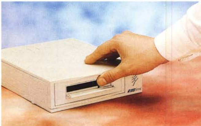
Per inserire un disco nell'unità è necessario prima aprire lo sportellino anteriore e poi richiuderlo manualmente. L'espulsione è automatica (vedi testo).
