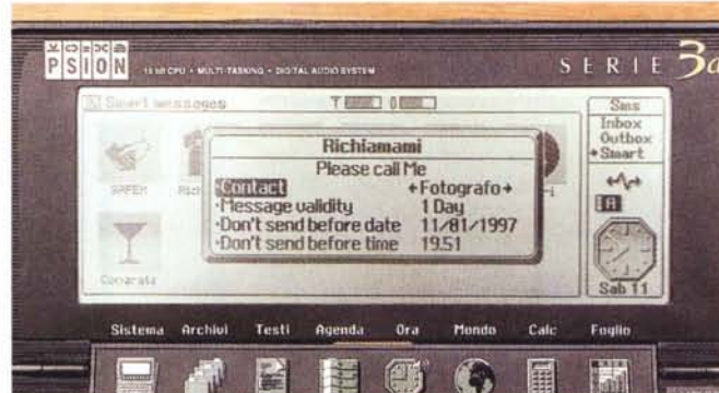
Alcune schermate del Palmtop Messenger. In alto le finestre InBox e OutBox contenenti i messaggi in arrivo e in partenza, in basso gli «Short Messages» che l'utente può definire per identificare alcuni messaggi di uso più frequente.
