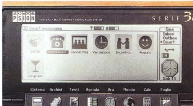
Alcune schermate del Palmtop Messenger. In alto le finestre InBox e OutBox contenenti i messaggi in arrivo e in partenza, in basso gli «Short Messages» che l'utente può definire per identificare alcuni messaggi di uso più frequente.
