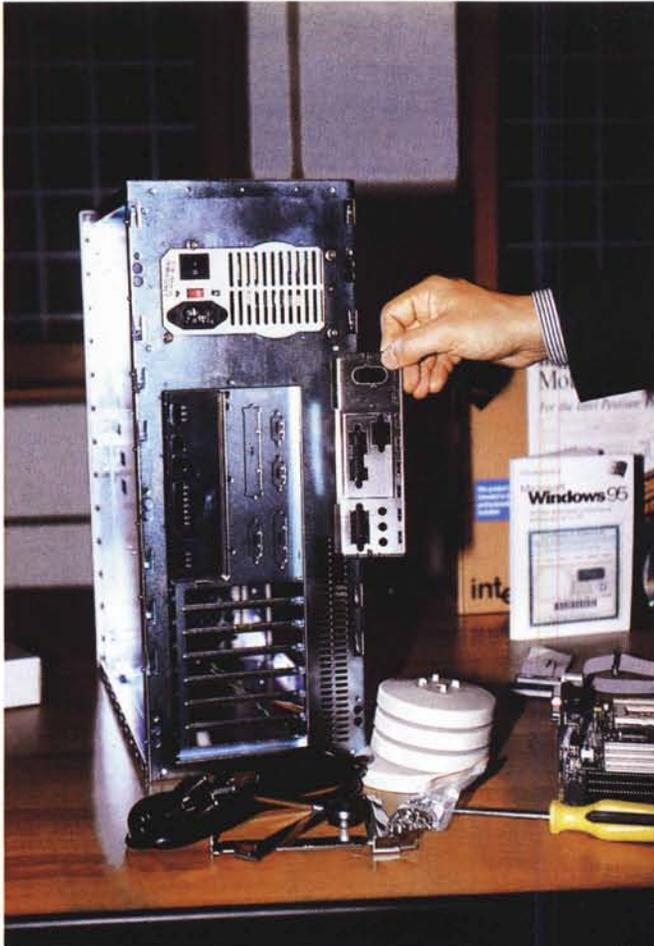
Lo standard ATX si concretizza in quello «shield» (scudo) che protegge e ospita al tempo stesso tutte le interfacce di I/O della piastra madre. Da sottolineare che la scheda audio on-board si basa su chipset Yamaha OPL3.
