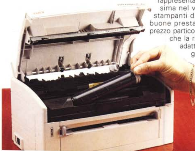
Una caratteristica della Okipage 4w è la possibilità di sostituzione della cartuccia toner indipendentemente dalla cartuccia del tamburo fotosensibile.
